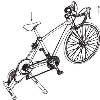
3. Empurre a alavanca de remoção rápida na plataforma de ciclismo para a posição “open”, instale a bicicleta na plataforma de ciclismo e alinhe a cadeia da bicicleta com o menor pedaço do volante de cassete na plataforma de ciclismo.
