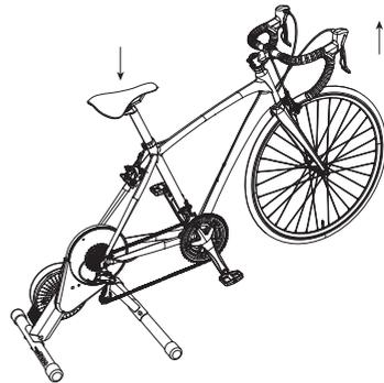
4. Levante la rueda delantera y presione hacia abajo el sillín para asegurarse de que la bicicleta está completamente montada en la mesa de ciclismo.
