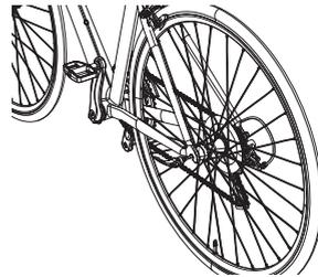
2. Suelte el freno trasero, abra el desenganche rápido, luego levante el bastidor y retire la rueda trasera hacia abajo.
