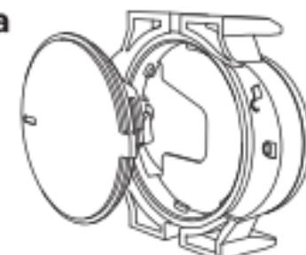
1. Gire en sentido antihorario la marca de posición en la tapa de la batería desde la posición de bloqueo hasta la de apertura para abrir el compartimento de la batería.
