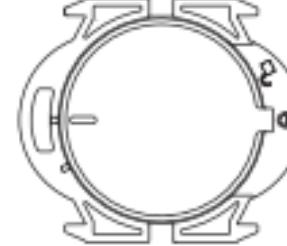
2. Установите новую батарею в батарейный отсек, совместите стрелочный указатель на крышке батарейного отсека с показателем открытого положения и нажмите на крышку; после полного нажатия поверните стрелочный указатель на крышке батарейного отсека в положение блокировки.
