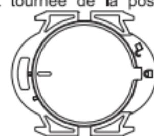
2. Placez la nouvelle pile dans le compartiment à piles, replacez le couvercle du compartiment à piles avec le repère de position alignée avec la position ouverte, assurez-vous qu'il est complètement enfoncé, puis tournez le couvercle du compartiment à piles dans le sens horaire jusqu'à ce que le repère de position soit alignée avec la position verrouillée.
