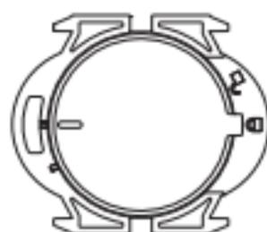
2. 新しい電池を電池室に入れ、電池カバーのマークをオープン状態の位置に合わせて押し込みます。完全に押し込まれていることを確認した後、電池カバーのマークを時計回りに回転させてロック状態にします。
