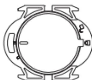
2. Coloque a nova bateria no compartimento da bateria, alinhe a marca de posição da tampa da bateria com a posição de abertura e pressione-a (como mostrado abaixo), certifique-se de que esteja totalmente pressionada, com uma moeda gire a marca de seta na tampa da bateria no sentido horário para a posição de bloqueio.
