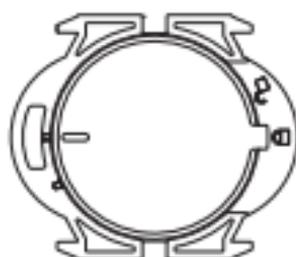
2. 새로운 배터리를 배터리 컴파트먼트에 넣고, 커버 상의 위치 표시를 오픈 위치에 맞춰 누른 후, 커버가 완전히 들어간 상태에서 시계 방향으로 렉 위치까지 돌리면 됩니다.
