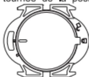
2. Placez la nouvelle pile dans le compartiment à piles, replacez le couvercle du compartiment à piles avec le repère de position alignée avec la position ouverte, assurez-vous qu'il est complètement enfoncé, puis tournez le couvercle du compartiment à piles dans le sens horaire jusqu'à ce que le repère de position soit alignée avec la position verrouillée.
