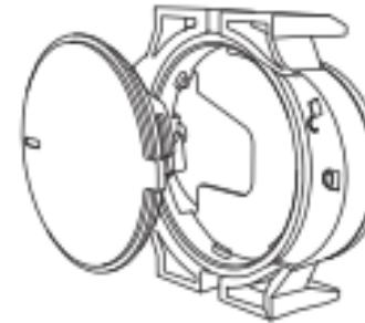
1. Поверните стрелочный указатель на крышке батарейного отсека против часовой стрелки из положения блокировки в положение открытия, чтобы открыть батарейный отсек.
