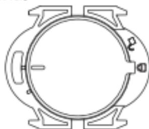
2. Coloque una batería nueva en el compartimento de la batería, alinee la marca de posición en la tapa de la batería con la posición de apertura y la encaje. Después de asegurarse de que la tapa de la batería esté completamente encajada, gire la marca en sentido horario hasta la posición de bloqueo.
