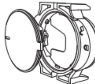
1. Usando uma moeda, gire a marca da seta na tampa da bateria no sentido anti-horário da posição de bloqueio à posição de abertura para abrir o compartimento da bateria.
