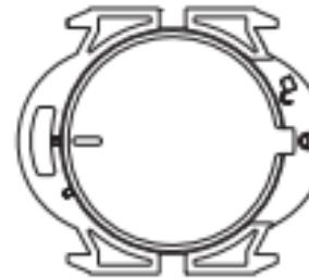
2. Coloque a nova bateria no compartimento da bateria, alinhe a marca de posição da tampa da bateria com a posição de abertura e pressione-a (como mostrado abaixo), certifique-se de que esteja totalmente pressionada, com uma moeda gire a marca de seta na tampa da bateria no sentido horário para a posição de bloqueio.
