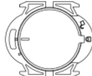
2. Coloque una batería nueva en el compartimento de la batería, alinee la marca de posición en la tapa de la batería con la posición de apertura y la encaje. Después de asegurarse de que la tapa de la batería esté completamente encajada, gire la marca en sentido horario hasta la posición de bloqueo.
