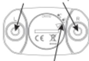
② Identificação da posição de rotação do compartimento da bateria
