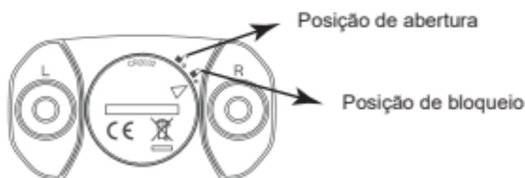
1. Usando uma moeda, gire a marca da seta na tampa da bateria no sentido anti-horário da posição de bloqueio à posição de abertura para abrir o compartimento da bateria
